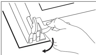
**Шаг 6** Сначала осторожно поднимите, а затем снимите стеклянную панель.
