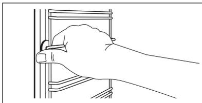
**Шаг 3** Вытяните заднюю часть направляющей в сторону от боковой стенки и снимите ее.
