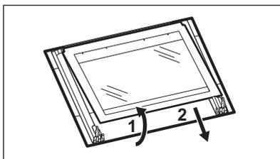
**Шаг 8** После очистки установите стеклянную панель и дверцу духового шкафа.
