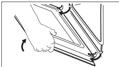
**Шаг 5** Поверните фиксаторы на 90° и извлеките их из своих гнезд.
